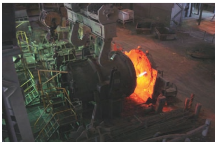
Traslado de cuchara para colar en una colada continua de barras redondas
